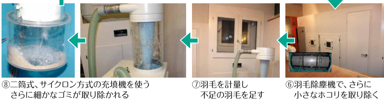
⑧一マスに充填する羽毛量を計量 中央部や衿元は厚めに入れる などきめ細かな充填量の調整 を行い、羽毛を側に吹き込んで いき、最後は縫製して完了! ⑨オゾン処理で殺菌脱臭 ソーティングで重いゴミ を取り除く
